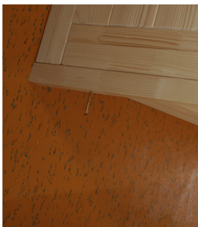
Fig. 47: Montaggio dei listelli distanziatori sul pannello posteriore
