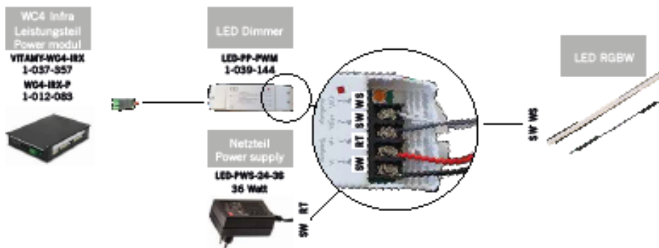
Fig. 44: Conexão da tira LED ao comando
