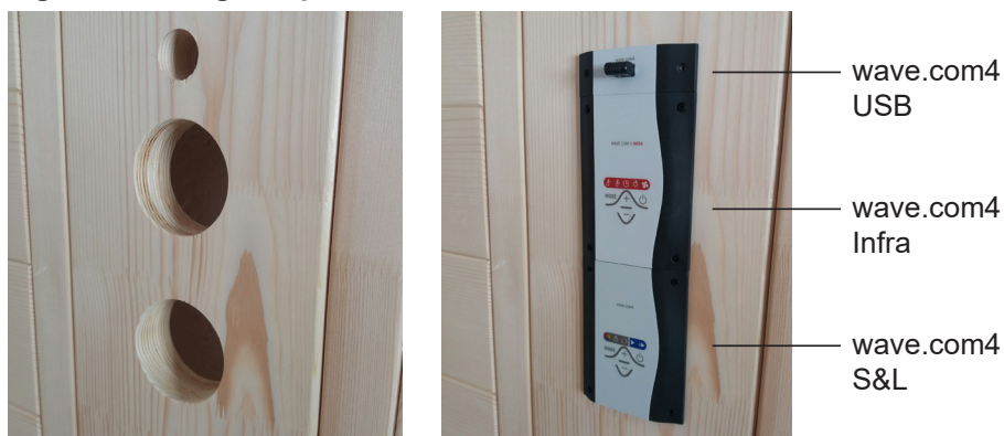
Fig. 44 : Montage du panneau de commande
