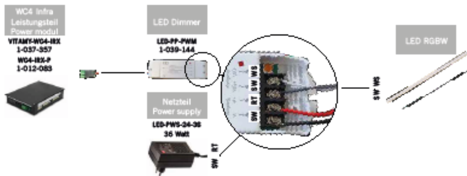
Afb. 44: Verbinden van de ledstrip met de besturing
