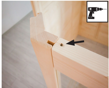
Broca de 3 mm, 1 parafuso de 4 x 70 mm
