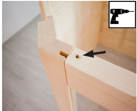
Bohrer 3 mm, 1 Stk. Schrauben 4 x 70 mm
