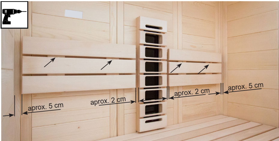
Broca de 3 mm, 4 parafusos de 4 x 70 mm
