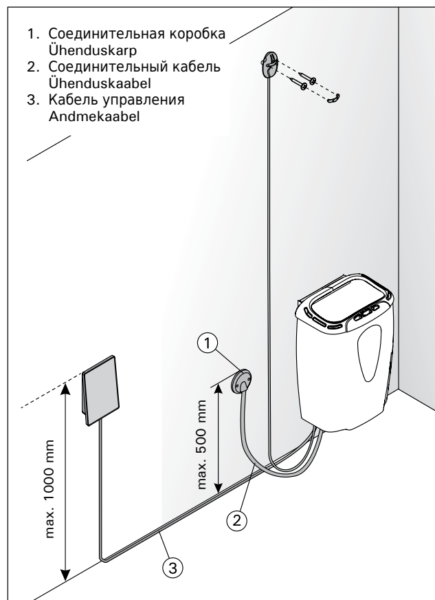
Рисунок 11. Установка каменки Joonis 11. Kerise ühendused
